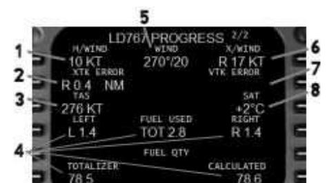
**CALCULATED** = Calcul par le FMC en fonction du fuel flow moins la quantité totale de fuel indiquée avant mise en route moteurs.
